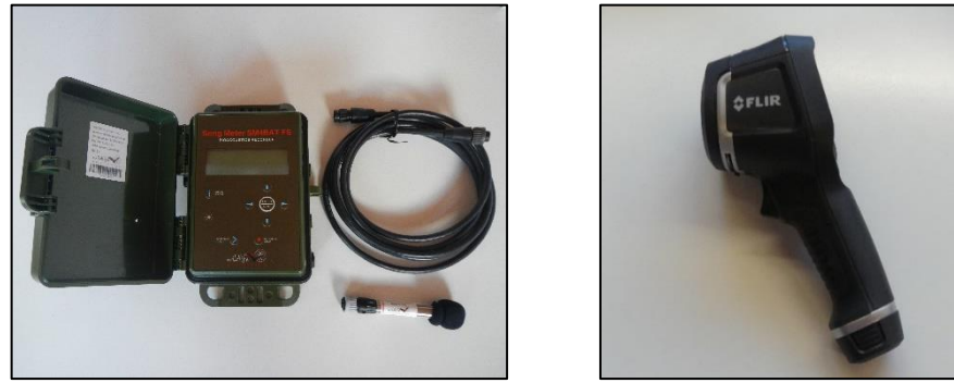
De gauche à droite : Enregistreur SM4BAT-FS Wildlife Acoustics et caméra thermique FLIR Photos : Artifex – 2018
